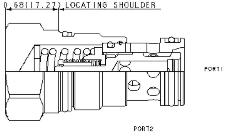
Fest eingestellter 2-Wege Stromregler zur genauen Einstellung von druckunabhängigen Volumenströmen bei Zulauf- und Ablaufregelung. Das integrierte Umgehungsrückschlagventil öffnet von Anschluss 2 nach 1. Der Volumenstrom wird werkseitig über eine Blende auf den vorgegebenen Wert eingestellt.
