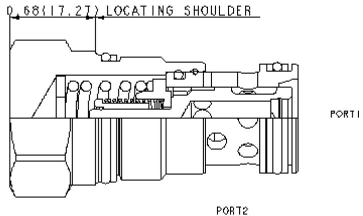
Les régulateurs de débit compensés en pression à orifice fixe, avec clapet de libre passage du débit inverse, fonctionnent en entrée ou en sortie de récepteur et assurent une régulation précise du débit même en cas d'importantes fluctuations de la pression. Un clapet intégral de grande capacité laisse passer le débit sans restriction de la chambre 2 vers la chambre 1. Le débit requis doit être spécifié par le client et le réglage est fait en usine.
