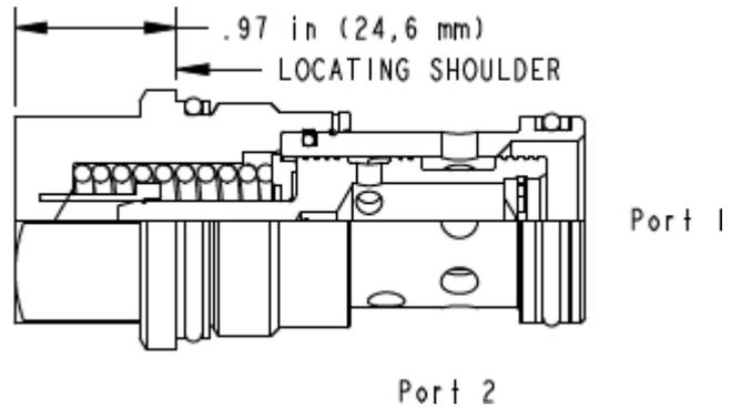
Fest eingestellter 2-Wege Stromregler zur genauen Einstellung von druckunabhängigen Volumenströmen bei Zulauf- und Ablaufregelung. Das integrierte Umgehungs-rückschlagventil öffnet von Anschluss 2 nach 1. Der Volumenstrom wird werkseitig über eine Blende auf den vorgegebenen Wert eingestellt.
