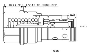
Fest eingestellter 2-Wege Stromregler zur genauen Einstellung von druckunabhängigen Volumenströmen bei Zulauf- und Ablaufregelung. Das integrierte Umgehungsrückschlagventil öffnet von Anschluss 2 nach 1. Der Volumenstrom wird werkseitig über eine Blende auf den vorgegebenen Wert eingestellt.
