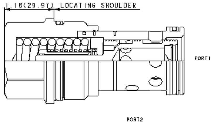
Les régulateurs de débit compensés en pression à orifice fixe, avec clapet de libre passage du débit inverse, fonctionnent en entrée ou en sortie de récepteur et assurent une régulation précise du débit même en cas d'importantes fluctuations de la pression. Un clapet intégral de grande capacité laisse passer le débit sans restriction de la chambre 2 vers la chambre 1. Le débit requis doit être spécifié par le client et le réglage est fait en usine.
