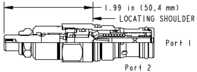
Les régulateurs de débit compensés en pression avec clapet de by-pass, réglables sur la totalité de la plage, fonctionnent en entrée ou en sortie de récepteur et assurent une régulation précise du débit même en cas d'importantes fluctuations de la pression. Ils permettent une infinité de réglages depuis la quasi fermeture jusqu'au débit maximum. Un clapet anti-retour de grande capacité laisse passer le débit sans restriction de la chambre 2 vers la chambre 1.
