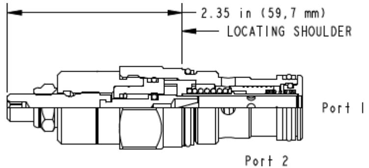
Voll verstellbarer 2-Wege Stromregler zur genauen Einstellung von druckunabhängigen Volumenströmen bei Zulauf- oder Ablaufregelung. Das integrierte Umgehungsrückschlagventil öffnet von Anschluss 2 nach 1. Der Volumenstrom kann über eine Stellspindel feinfühlig und stufenlos von minimal bis maximal verstellt werden.
