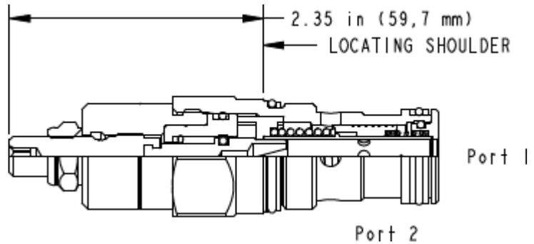
Les régulateurs de débit compensés en pression avec clapet de by-pass, réglables sur la totalité de la plage, fonctionnent en entrée ou en sortie de récepteur et assurent une régulation précise du débit même en cas d'importantes fluctuations de la pression. Ils permettent une infinité de réglages depuis la quasi fermeture jusqu'au débit maximum. Un clapet anti-retour de grande capacité laisse passer le débit sans restriction de la chambre 2 vers la chambre 1.
