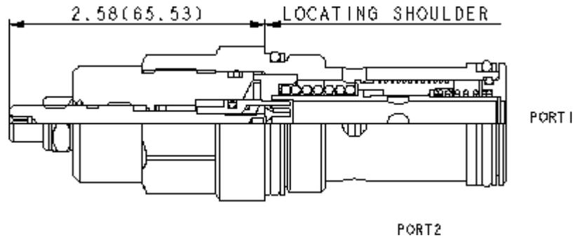
Voll verstellbarer 2-Wege Stromregler zur genauen Einstellung von druckunabhängigen Volumenströmen bei Zulauf- oder Ablaufregelung. Das integrierte Umgehungs Rückschlagventil öffnet von Anschluss 2 nach 1. Der Volumenstrom kann über eine Stellspindel feinfühlig und stufenlos von minimal bis maximal verstellt werden.
