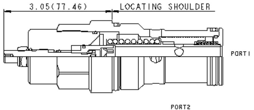
Les régulateurs de débit compensés en pression avec clapet de by-pass, réglables sur la totalité de la plage, fonctionnent en entrée ou en sortie de récepteur et assurent une régulation précise du débit même en cas d'importantes fluctuations de la pression. Ils permettent une infinité de réglages depuis la quasi fermeture jusqu'au débit maximum. Un clapet anti-retour de grande capacité laisse passer le débit sans restriction de la chambre 2 vers la chambre 1.
