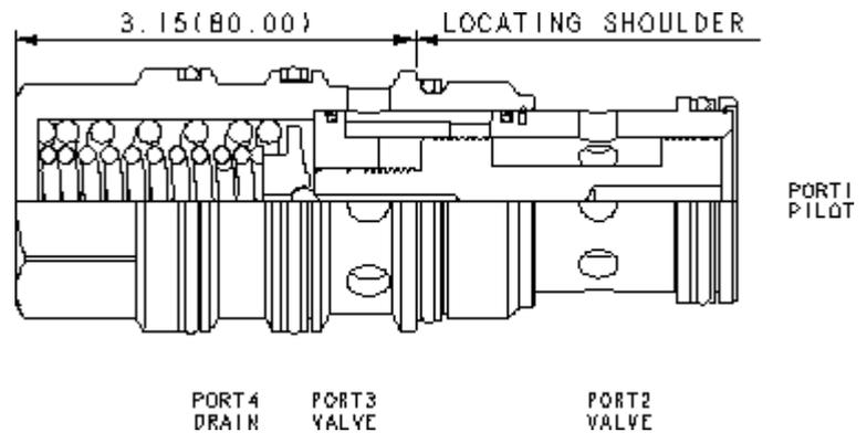
Dieses Ventil ist ein 2/2-Wegeventil. Es arbeitet als Proportionaldrossel. Die Anschlüsse 2 und 3 sind in Ruhestellung geschlossen. Steuerdruck an Anschluss 1 erzeugt eine Drosselstelle zwischen den Anschlüssen 2 und 3, die proportional zum Druck an 1 ist. Das Ventil ist teilweise selbstkompensierend. Die Drücke an den Anschlüssen 4 und 1 wirken einander direkt entgegen.
