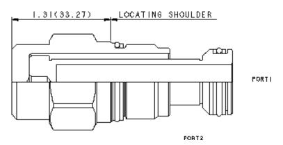
SUN Filter sind erhältlich als Oberflächen- (Schutzfilter) Und Tiefenfilterelemente. Die Durchflussrichtung ist immer von Anschluss 2 nach 1 und darf nicht umgekehrt werden, selbst dann nicht, wenn ein Umgehungsrückschlagventil installiert ist. Die Filterelemente haben einen hohen Berstdruck und werden Inline im System eingebaut. Die Filterlebensdauer hängt von der Anfangssauberkeit des Systems und dem Schmutzeintrag ab.
