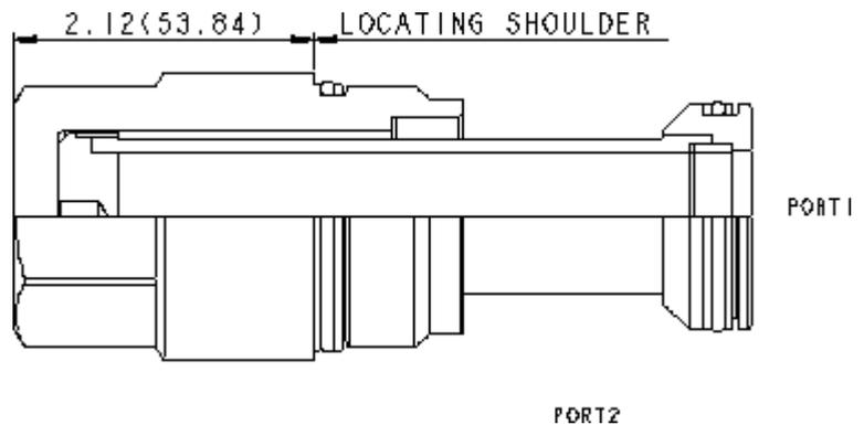
SUN Filter sind erhältlich als Oberflächen- (Schutzfilter) Und Tiefenfilterelemente. Die Durchflussrichtung ist immer von Anschluss 2 nach 1 und darf nicht umgekehrt werden, selbst dann nicht, wenn ein Umgehungs Rückschlagventil installiert ist. Die Filterelemente haben einen hohen Berstdruck und werden Inline im System eingebaut. Die Filterlebensdauer hängt von der Anfangssauberkeit des Systems und dem Schmutzeintrag ab.
