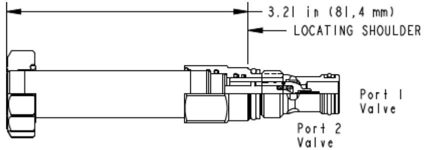
Das Ventil ist eine vorgesteuerte, in Ruhestellung geschlossene, elektroproportionale Drossel mit integriertem Rückschlagventil. Wird die Spule mit Strom versorgt, öffnet die Vorsteuerstufe. Dadurch wird die Hauptstufe entlastet und das Ventil öffnet proportional von Anschluss 2 nach 1. Das Rückschlagventil ermöglicht einen Volumenstrom von Anschluss 1 nach 2 bei geöffnetem und geschlossenem Ventil.
