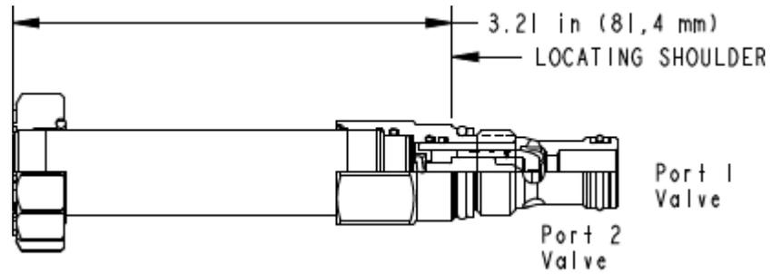
Das Ventil ist eine vorgesteuerte, in Ruhestellung geöffnete, elektroproportionale Drossel mit integriertem Rückschlagventil. Wird die Spule mit Strom versorgt, schließt die Vorsteuerstufe. Dadurch wird die Hauptstufe gesperrt und das Ventil schließt proportional von Anschluss 2 nach 1. Ein geöffnetes Ventil wird durch einen Volumenstrom von Anschluss 1 nach 2 automatisch geschlossen und es fließt ein Steuerölstrom von Anschluss 1 nach 2.
