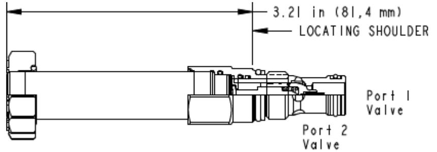
Das Ventil ist eine vorgesteuerte, in Ruhestellung geöffnete, elektroproportionale Drossel mit integriertem Rückschlagventil. Wird die Spule mit Strom versorgt, schließt die Vorsteuerstufe. Dadurch wird die Hauptstufe gesperrt und das Ventil schließt proportional von Anschluss 2 nach 1. Das Rückschlagventil ermöglicht einen Volumenstrom von Anschluss 1 nach 2 bei geöffnetem und geschlossenem Ventil.
