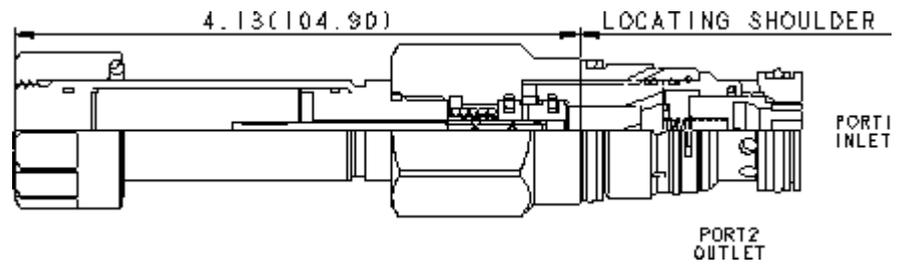
Cette valve est un étrangleur de débit électro-proportionnel piloté, normalement fermé, avec un clapet pour passage libre en sens inverse. La mise sous tension de la bobine génère une force d'ouverture au niveau de l'étage pilote qui soulève le clapet de l'étage principale en proportion. Le débit est régulé de 1 vers 2 et passe librement par le clapet de 2 vers 1.
