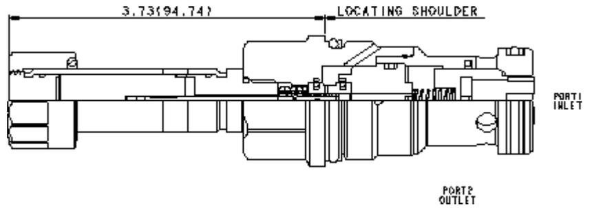
Cette valve est un étrangleur de débit électro-proportionnel piloté, normalement fermé, avec un clapet pour passage libre en sens inverse. La mise sous tension de la bobine génère une force d'ouverture au niveau de l'étage pilote qui soulève le clapet de l'étage principale en proportion. Le débit est régulé de 1 vers 2 et passe librement par le clapet de 2 vers 1.
