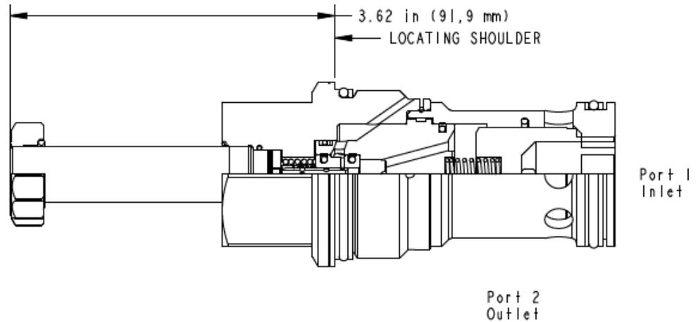
Dieses Ventil ist eine vorgesteuerte Elektro-Proportionaldrossel mit geschlossener Ruhstellung und integriertem Umgehungsrückschlagventil. Bestromen der Spule erzeugt eine öffnende Kraft in der Vorsteuerstufe, wodurch der Hauptstufenkolben entlastet wird und proportional öffnet. Der geregelte Durchfluss ist von Anschluss 1 nach 2, das Umgehungsrückschlagventil öffnet von Anschluss 2 nach 1.
