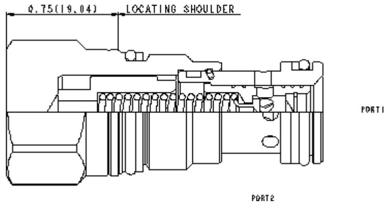
Mit Rohrbruchsicherungen kann die Position eines Hydraulikantriebs bei Rohrbruch gehalten werden. Im Normalbetrieb ist das Ventil offen und lässt Öl zum und vom Verbraucher fließen. Bei Rohrbruch schließt das Ventil sofort, wenn der Volumenstrom den Einstellwert am Ventil überschreitet. Hinweis: Rohrbruchsicherungen reagieren sehr schnell und schalten bereits bei kurzfristiger Überschreitung der Ventileinstellung.
