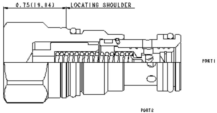
Les valves parachute en cartouche maintiennent un récepteur en position en cas de rupture de flexible. La valve laisse circuler le débit venant ou allant au récepteur mais se ferme instantanément si le débit venant du récepteur excède le tarage de la valve. Note : Parce que la valve a un temps de réponse extrêmement court, elle est sensible à toute pointe de débit dépassant son tarage.
