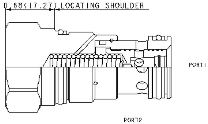
Les valves parachute en cartouche maintiennent un récepteur en position en cas de rupture de flexible. La valve laisse circuler le débit venant ou allant au récepteur mais se ferme instantanément si le débit venant du récepteur excède le tarage de la valve. Note : Parce que la valve a un temps de réponse extrêmement court, elle est sensible à toute pointe de débit dépassant son tarage.
