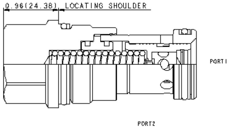
Les valves parachute en cartouche maintiennent un récepteur en position en cas de rupture de flexible. La valve laisse circuler le débit venant ou allant au récepteur mais se ferme instantanément si le débit venant du récepteur excède le tarage de la valve. Note : Parce que la valve a un temps de réponse extrêmement court, elle est sensible à toute pointe de débit dépassant son tarage.
