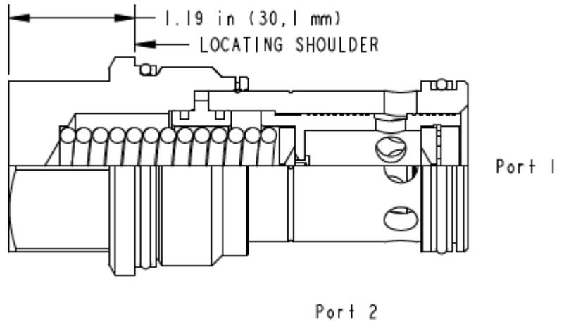
Les valves parachute en cartouche maintiennent un récepteur en position en cas de rupture de flexible. La valve laisse circuler le débit venant ou allant au récepteur mais se ferme instantanément si le débit venant du récepteur excède le tarage de la valve. Note : Parce que la valve a un temps de réponse extrêmement court, elle est sensible à toute pointe de débit dépassant son tarage.
