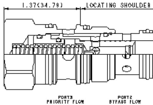
Vorzugsstromregelventile mit fest eingestellter Blende regeln den Volumenstrom von Anschluss 1 nach 3. Überschüssiger Volumstrom wird aus Anschluss 2 abgeleitet. Das Ventil ist reststrombelastbar.
