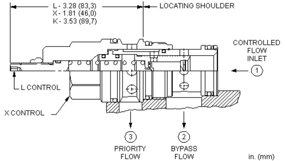
Vorzugsstromregelventile mit fest eingestellter Blende regeln den Volumenstrom von Anschluss 1 nach 3. Überschüssiger Volumstrom wird aus Anschluss 2 abgeleitet. Das Ventil ist reststrombelastbar.
