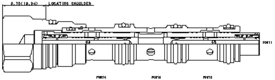
Les diviseurs/réunisseurs de débit à centre fermé sont des dispositifs à tiroir coulissant, compensés en pression, utilisés pour séparer le débit dans un sens et pour le combiner dans le sens inverse. Ces valves peuvent être employées pour contrôler avec précision 2 vérins ou plus, ou bien des moteurs hydrauliques, quand leur fonctionnement est bidirectionnel.
