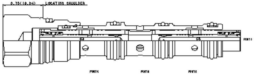
Stromteiler/Vereiniger in Schieberkonstruktion teilen einen eingehenden Volumenstrom in einem fest vorgegebenen Teilungsverhältnis druckunabhängig in zwei Teilströme. In umgekehrter Richtung werden die eingehenden Teilströme in gleicher Weise vereinigt. Wird ein Anschluss gesperrt, ist die Schieberkonstruktion geschlossen. Typisches Anwendungsbeispiel: Steuerungen, bei denen der Gleichlauf von Zylindern oder Hydraulikmotoren in beiden Richtungen gefordert ist.
