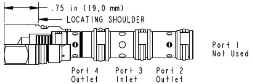
Stromteiler in Schieberkonstruktion teilen einen eingehenden Volumenstrom in einem fest vorgegebenen Teilungsverhältnis druckunabhängig in zwei Teilströme. Typische Anwendungsbeispiele: Steuerung von Hydraulikmotoren mit nur einer Drehrichtung, Zylindersteuerungen, bei denen die Stromteilung nur in einer Richtung erfolgen muss, Systeme mit nur einer Pumpe, aber zwei unabhängigen Teilströmen.
