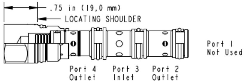
Les diviseurs de débit sont des dispositifs à tiroir coulissant, compensés en pression, utilisés pour séparer le débit en 2 branches différentes dans une proportion déterminée. Ces valves sont adaptées aux applications suivantes: Moteurs hydrauliques à un sens de marche, vérins pour lesquels la division est requise dans une seule direction, circuits multiples alimentés depuis une seule pompe.
