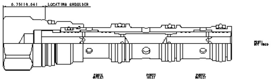
Stromteiler in Schieberkonstruktion teilen einen eingehenden Volumenstrom in einem fest vorgegebenen Teilungsverhältnis druckunabhängig in zwei Teilströme. Typische Anwendungsbeispiele: Steuerung von Hydraulikmotoren mit nur einer Drehrichtung, Zylindersteuerungen, bei denen die Stromteilung nur in einer Richtung erfolgen muss, Systeme mit nur einer Pumpe, aber zwei unabhängigen Teilströmen.
