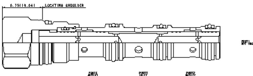
Les diviseurs de débit sont des dispositifs à tiroir coulissant, compensés en pression, utilisés pour séparer le débit en 2 branches différentes dans une proportion déterminée. Ces valves sont adaptées aux applications suivantes: Moteurs hydrauliques à un sens de marche, vérins pour lesquels la division est requise dans une seule direction, circuits multiples alimentés depuis une seule pompe.
