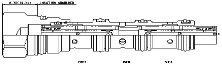
Les diviseurs/réunisseurs de débit "haute capacité" à centre fermé sont des dispositifs à tiroir coulissant, compensés en pression, utilisés pour séparer le débit dans un sens et pour le combiner dans le sens inverse. Ces valves ont une capacité en débit environ 15 % supérieure aux diviseurs/réunisseurs à centre fermé standard et sont destinées à être utilisées dans les transmissions. Note: la précision de ces cartouches est différente de celle des valves à centre fermé standard.
