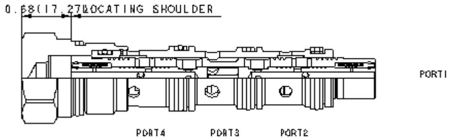
Les diviseurs/réunisseurs de débit à centre fermé sont des dispositifs à tiroir coulissant, compensés en pression, utilisés pour séparer le débit dans un sens et pour le combiner dans le sens inverse. Ces valves peuvent être employées pour contrôler avec précision 2 vérins ou plus, ou bien des moteurs hydrauliques, quand leur fonctionnement est bidirectionnel.
