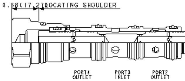
Les diviseurs de débit sont des dispositifs à tiroir coulissant, compensés en pression, utilisés pour séparer le débit en 2 branches différentes dans une proportion déterminée. Ces valves sont adaptées aux applications suivantes: Moteurs hydrauliques à un sens de marche, vérins pour lesquels la division est requise dans une seule direction, circuits multiples alimentés depuis une seule pompe.
