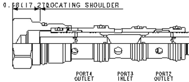
Stromteiler in Schieberkonstruktion teilen einen eingehenden Volumenstrom in einem fest vorgegebenen Teilungsverhältnis druckunabhängig in zwei Teilströme. Typische Anwendungsbeispiele: Steuerung von Hydraulikmotoren mit nur einer Drehrichtung, Zylindersteuerungen, bei denen die Stromteilung nur in einer Richtung erfolgen muss, Systeme mit nur einer Pumpe, aber zwei unabhängigen Teilströmen.
