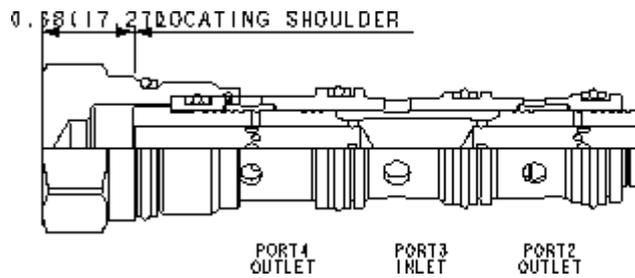
Les diviseurs de débit sont des dispositifs à tiroir coulissant, compensés en pression, utilisés pour séparer le débit en 2 branches différentes dans une proportion déterminée. Ces valves sont adaptées aux applications suivantes: Moteurs hydrauliques à un sens de marche, vérins pour lesquels la division est requise dans une seule direction, circuits multiples alimentés depuis une seule pompe.
