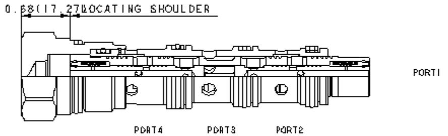
Les diviseurs/réunisseurs de débit "haute capacité" à centre fermé sont des dispositifs à tiroir coulissant, compensés en pression, utilisés pour séparer le débit dans un sens et pour le combiner dans le sens inverse. Ces valves ont une capacité en débit environ 15 % supérieure aux diviseurs/réunisseurs à centre fermé standard et sont destinées à être utilisées dans les transmissions. Note: la précision de ces cartouches est différente de celle des valves à centre fermé standard.
