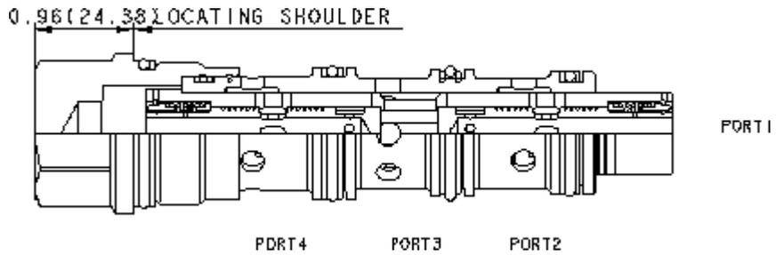
Stromteiler/Vereiniger in Schieberkonstruktion teilen einen eingehenden Volumenstrom in einem fest vorgegebenen Teilungsverhältnis druckunabhängig in zwei Teilströme. In umgekehrter Richtung werden die eingehenden Teilströme in gleicher Weise vereinigt. Wird ein Anschluss gesperrt, ist die Schieberkonstruktion geschlossen. Typisches Anwendungsbeispiel: Steuerungen, bei denen der Gleichlauf von Zylindern oder Hydraulikmotoren in beiden Richtungen gefordert ist.
