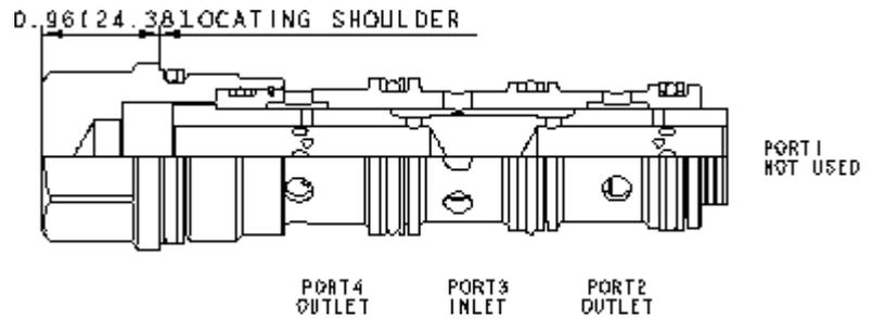
Stromteiler in Schieberkonstruktion teilen einen eingehenden Volumenstrom in einem fest vorgegebenen Teilungsverhältnis druckunabhängig in zwei Teilströme. Typische Anwendungsbeispiele: Steuerung von Hydraulikmotoren mit nur einer Drehrichtung, Zylindersteuerungen, bei denen die Stromteilung nur in einer Richtung erfolgen muss, Systeme mit nur einer Pumpe, aber zwei unabhängigen Teilströmen.
