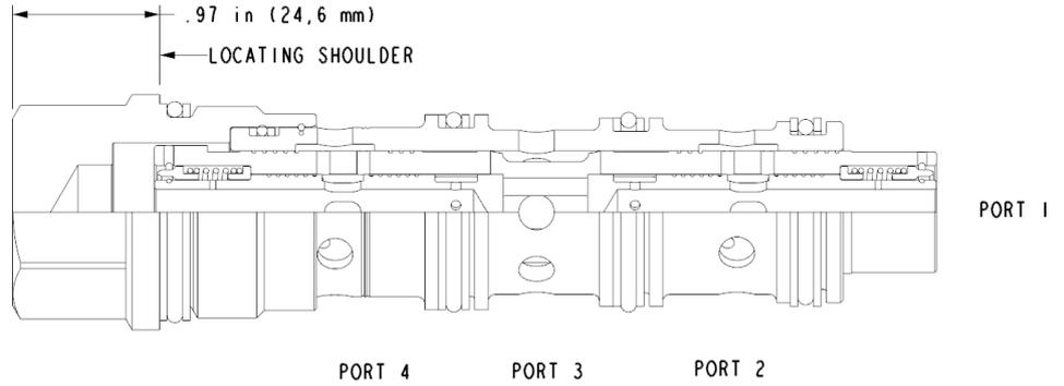
Les diviseurs/réunisseurs de débit "haute précision" à centre fermé sont des dispositifs à tiroir coulissant, compensés en pression, utilisés pour séparer le débit dans un sens et pour le combiner dans le sens inverse. Ces valves peuvent être employées pour contrôler avec précision 2 vérins ou plus, ou bien des moteurs hydrauliques, quand leur fonctionnement est bidirectionnel.
