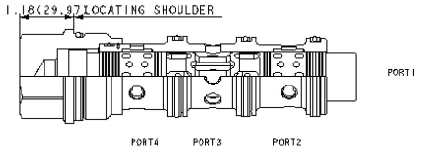
Les diviseurs/réunisseurs de débit à centre fermé sont des dispositifs à tiroir coulissant, compensés en pression, utilisés pour séparer le débit dans un sens et pour le combiner dans le sens inverse. Ces valves peuvent être employées pour contrôler avec précision 2 vérins ou plus, ou bien des moteurs hydrauliques, quand leur fonctionnement est bidirectionnel.
