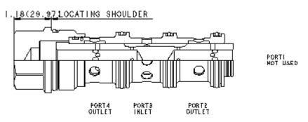
Stromteiler in Schieberkonstruktion teilen einen eingehenden Volumenstrom in einem fest vorgegebenen Teilungsverhältnis druckunabhängig in zwei Teilströme. Typische Anwendungsbeispiele: Steuerung von Hydraulikmotoren mit nur einer Drehrichtung, Zylindersteuerungen, bei denen die Stromteilung nur in einer Richtung erfolgen muss, Systeme mit nur einer Pumpe, aber zwei unabhängigen Teilströmen.
