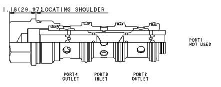
Les diviseurs de débit sont des dispositifs à tiroir coulissant, compensés en pression, utilisés pour séparer le débit en 2 branches différentes dans une proportion déterminée. Ces valves sont adaptées aux applications suivantes: Moteurs hydrauliques à un sens de marche, vérins pour lesquels la division est requise dans une seule direction, circuits multiples alimentés depuis une seule pompe.
