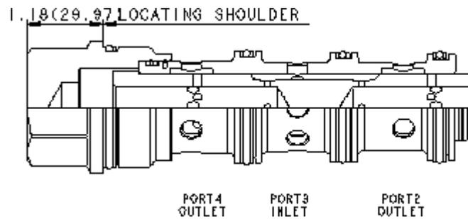
Stromteiler in Schieberkonstruktion teilen einen eingehenden Volumenstrom in einem fest vorgegebenen Teilungsverhältnis druckunabhängig in zwei Teilströme. Typische Anwendungsbeispiele: Steuerung von Hydraulikmotoren mit nur einer Drehrichtung, Zylindersteuerungen, bei denen die Stromteilung nur in einer Richtung erfolgen muss, Systeme mit nur einer Pumpe, aber zwei unabhängigen Teilströmen.
