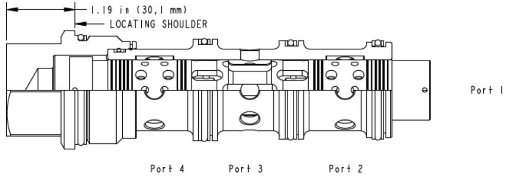
Les diviseurs/réunisseurs de débit "haute précision" à centre fermé sont des dispositifs à tiroir coulissant, compensés en pression, utilisés pour séparer le débit dans un sens et pour le combiner dans le sens inverse. Ces valves peuvent être employées pour contrôler avec précision 2 vérins ou plus, ou bien des moteurs hydrauliques, quand leur fonctionnement est bidirectionnel.
