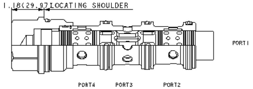
Les diviseurs/réunisseurs de débit "haute capacité" à centre fermé sont des dispositifs à tiroir coulissant, compensés en pression, utilisés pour séparer le débit dans un sens et pour le combiner dans le sens inverse. Ces valves ont une capacité en débit environ 15 % supérieure aux diviseurs/réunisseurs à centre fermé standard et sont destinées à être utilisées dans les transmissions. Note: la précision de ces cartouches est différente de celle des valves à centre fermé standard.
