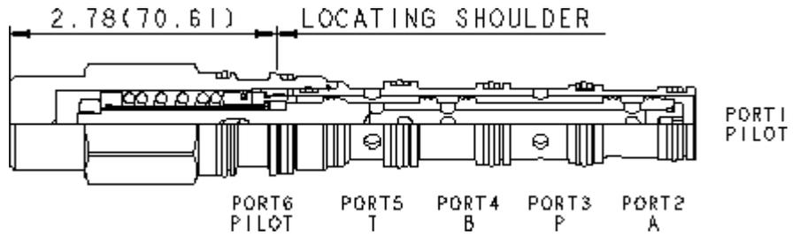
Dieses Ventil ist ein 4/3-Wegeventil. Es arbeitet als Proportionaldrossel. Die Anschlüsse 2 und 4 sind in Mittelstellung entlastet nach 5, Anschluss 3 ist geschlossen. Steuerdruck an Anschluss 1 wirkt gegen die Feder und erzeugt eine Drosselstelle zwischen Anschluss 3 und 4, die proportional zum Druck an 1 ist. Steuerdruck an Anschluss 6 öffnet 3 nach 2. Das Ventil ist teilweise selbstkompensierend. Die Drücke an den Anschlüssen 1 und 6 wirken einander direkt entgegen.
