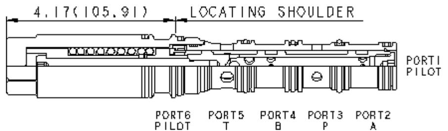
Dieses Ventil ist ein 4/3-Wegeventil. Es arbeitet als Proportionaldrossel. Die Anschlüsse 2 und 4 sind in Mittelstellung entlastet nach 5, Anschluss 3 ist geschlossen. Steuerdruck an Anschluss 1 wirkt gegen die Feder und erzeugt eine Drosselstelle zwischen Anschluss 3 und 4, die proportional zum Druck an 1 ist. Steuerdruck an Anschluss 6 öffnet 3 nach 2. Das Ventil ist teilweise selbstkompensierend. Die Drücke an den Anschlüssen 1 und 6 wirken einander direkt entgegen.
