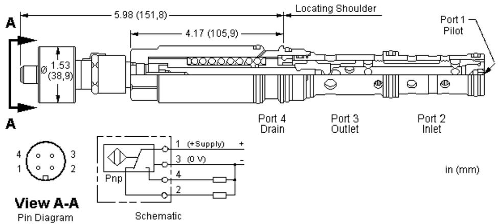
此阀是2位2通比例节流阀。口2、3和口4、5常闭。口1先导压力抵抗弹簧力会在口2、3到口4、5方向上形成一个与口1压力大小成比例的可变节流口。节流口有一定程度的自补偿效果。此阀使用双通道设计。口2、3、4、5结合而形成口2、3和口4、5。一双口可看成单独区域来对待。此阀利用切换活塞来保证阀可靠关闭。
